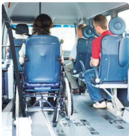
Im Boden integrierte Vierpunktrollstuhlfesthalterung. Dreipunkt-rollstuhlunabhängiger Sicherheitsgurt.
